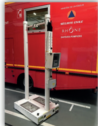
Portiques de détection radiologiques
