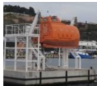
Canot de sauvetage complètement fermé, équipé d'un dispositif de pulvérisation d'eau et d'un système autonome d'approvisionnement en air.
