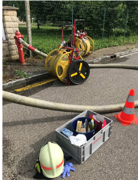
Un nettoyage maximum des EPI et matériels est préconisé sur les lieux des opérations, afin de limiter tout transfert dans le véhicule et l'exposition des sapeurs-pompiers. © Djamel Ferrand – DGSCGC
